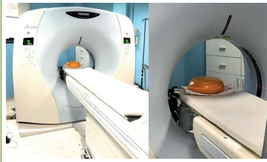
FIGURA 1 - Tomógrafo utilizado para el análisis de los quesos.
